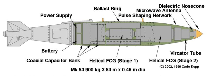
HIGH POWER MICROWAVE E-BOMB - GENERAL ARRANGMENT MK.84 PACKAGING WARHEAD USING VIRCATOR AND 2 STAGE FLUX COMPRESSION GENERATOR
